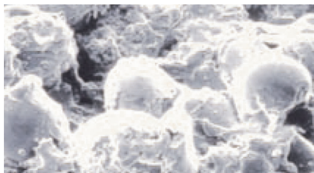
Figura 9: Las partículas de titanio de forma irregular pulverizadas sobre el sustrato provocan una amplia distribución de tamaños de poro.
